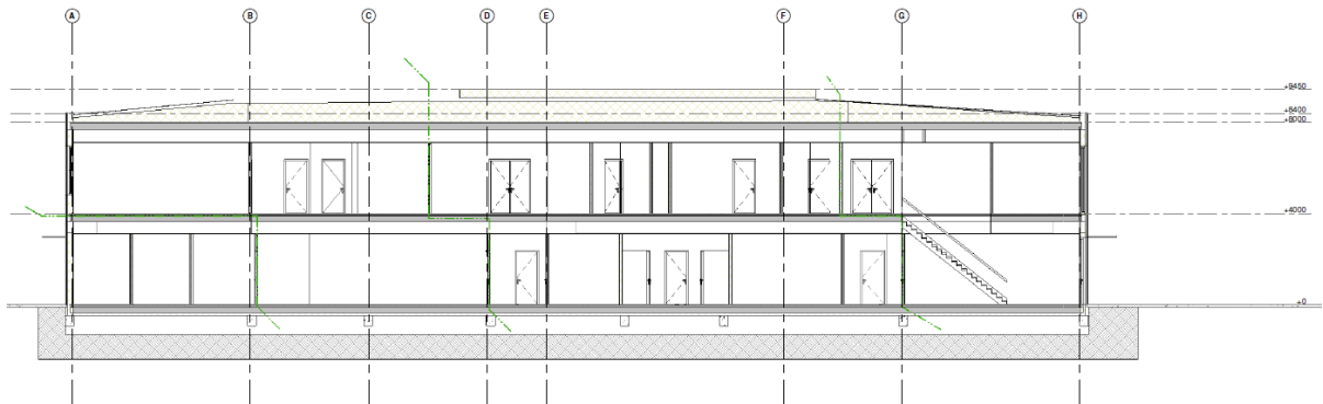
Figuur 17 Brandscheidingen Doorsnede B-B
